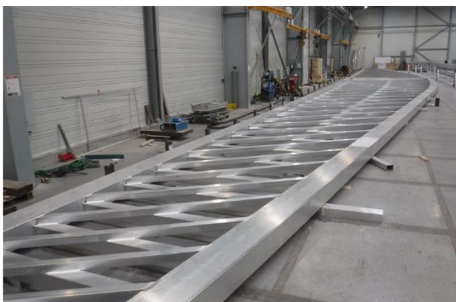
La construction et le montage de la passerelle ont débuté au mois de mars dans les ateliers de la société Atlantic Marine à Fontenay-le-Comte en Vendée. L'objectif est de transporter chacune des deux sections de la passerelle par convoi exceptionnel, puis de procéder
