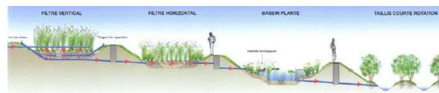
Jardins filtrants par macrophytes d'après « L'assainissement écologique des eaux usées domestiques » par Dominique Dupont Architecte DPLG
